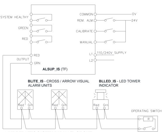
2-WIRE TRAFFIC SYSTEM PARALLEL CIRCUIT
